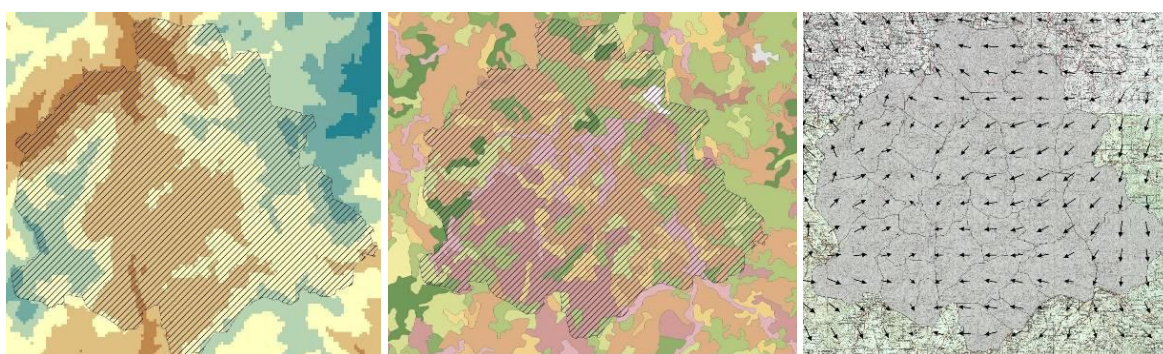
Figura 9 – Inputs ao modelo de dispersão aplicado a um concelho: uso do solo, topografia e campo de ventos
