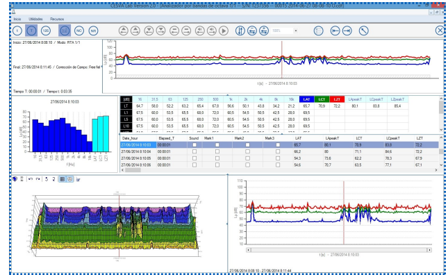
Modo analisador espectral por oitavas 1/1 [O]
